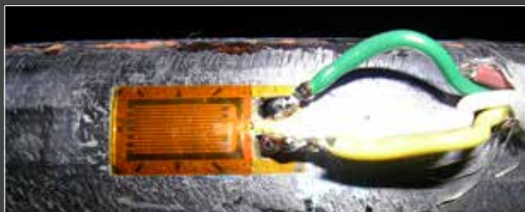
STRAIN GAUGE SU ACCIAIO
