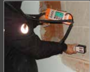
INDAGINE MAGNETOMETRICA SU SETTO IN C.A.
