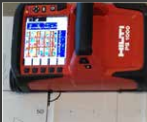
SCANSIONE PROFONDA DEGLI ELEMENTI STRUTTURALI IN CEMENTO ARMATO
