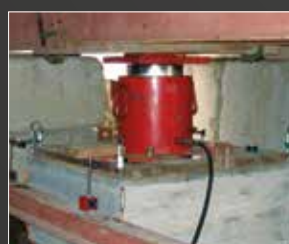
CARICO E MISURE SU PALO DI FONDAZIONE
