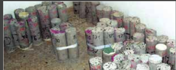
CAMPAGNA CONOSCITIVA SU CALCESTRUZZO A.M. BASE AEREA DI SIGONELLA (SR)
